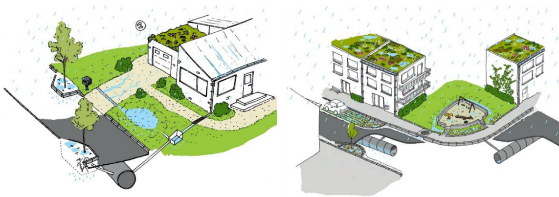
Figuur 9. Opvang en infiltratie van hemelwater bij frequente neerslag © Aquafin
