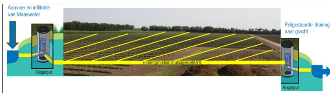
Figuur 39: Principeschets subirrigatie (Boerennatuur, 2023)
